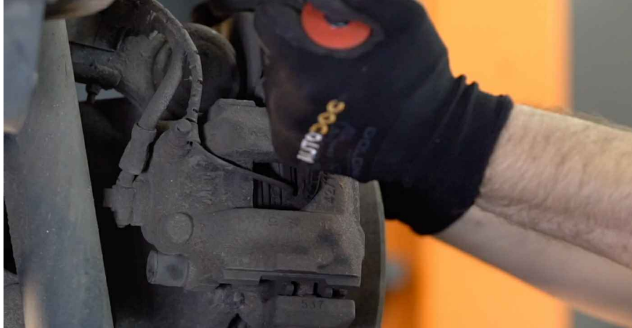
11 Verwijder de stofkappen van de geleidepennen van de remklauw. Gebruik een koevoet.
