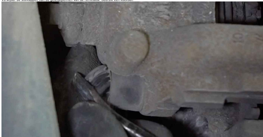
12 Schroef de bevestiging van de remklauw los. Gebruik inbusseutel nr. H7. Gebruik een ratelsleutel.
