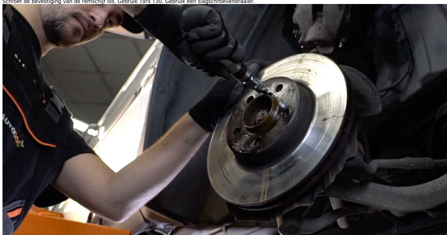
Vervanging: remschijven - BMW X5 E53. Tip: • Gebruik indien nodig een rubberhamer.
