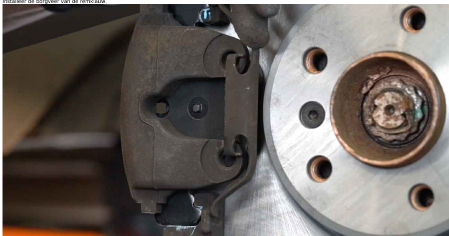
33 Reinig het oppervlak van de remschijf. Gebruik een remmenreiniger.
