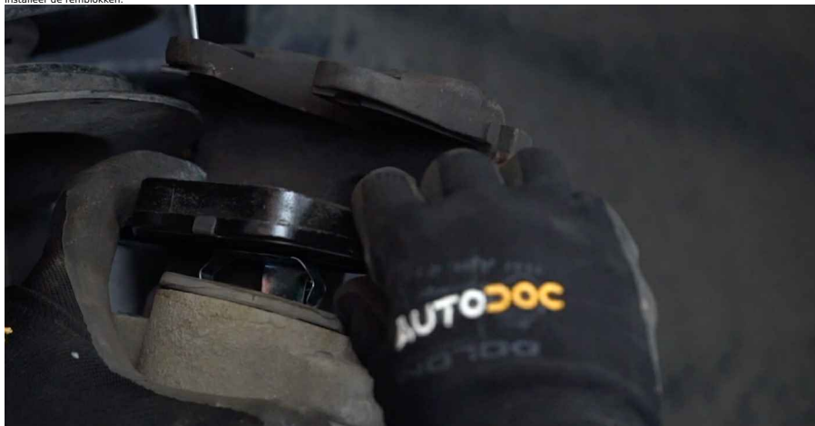
30 Installeer de remklaauw en zet deze vast. Gebruik inbussleutel nr. H7. Gebruik een momentsleutel. Draai deze vast tot een koppel van 30 Nm.
