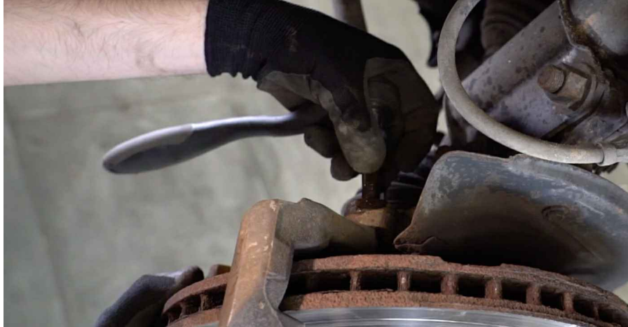
19 Reinig het oppervlak van de remschijf. Gebruik een staalborstel. Gebruik de WD-40 spray.
