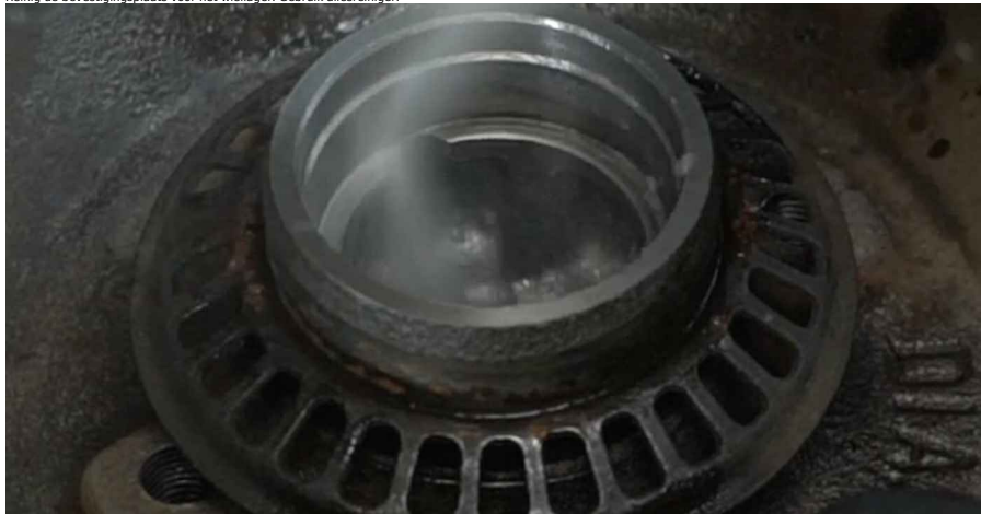
18 Plaats een nieuwe buitenste wiellagerloopping in de remtrommel. Uldrijfset voor lagere en bussen.
