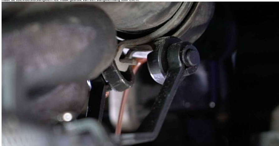
8 Koppel de koelvloeistofslang af.
