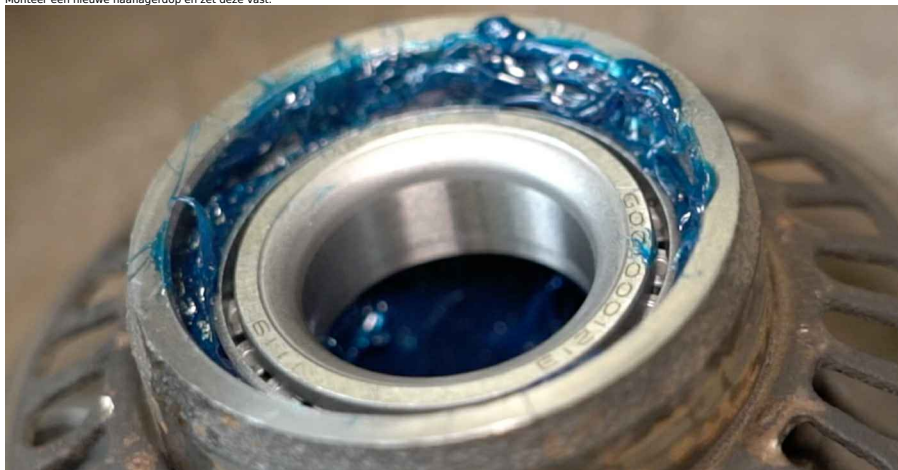
22 Monteer de oliekeerring voor het wiellager.
