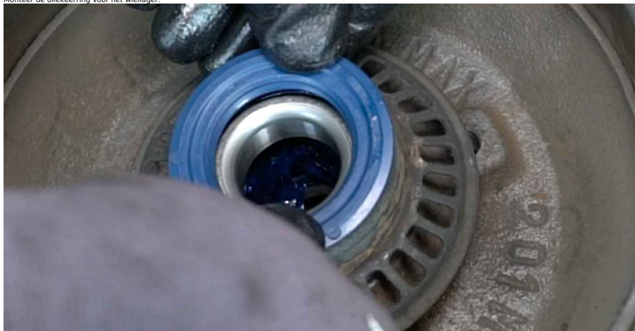
23 Behandel de asstomp. Gebruik allesreiniger. Gebruik lagervet.
