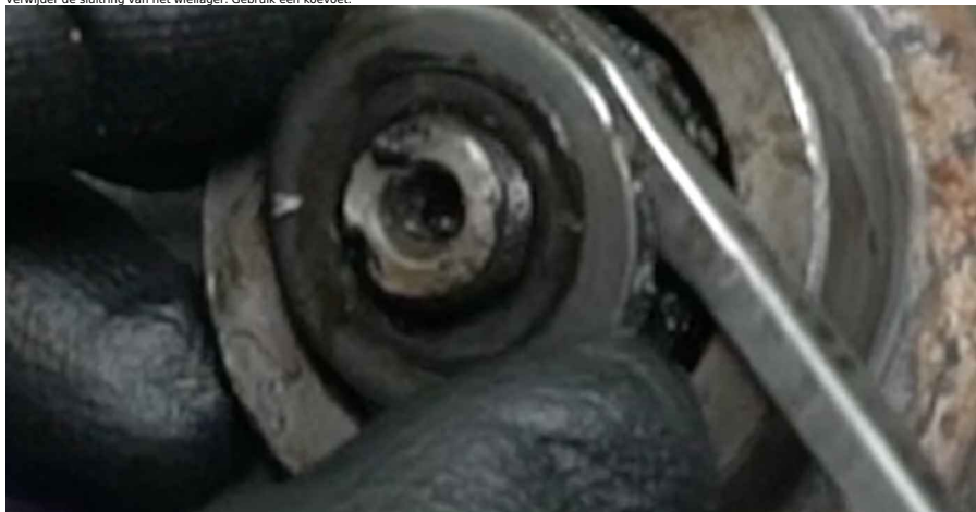
10 Verwijder het wiellager. Gebruik een koevoet.
