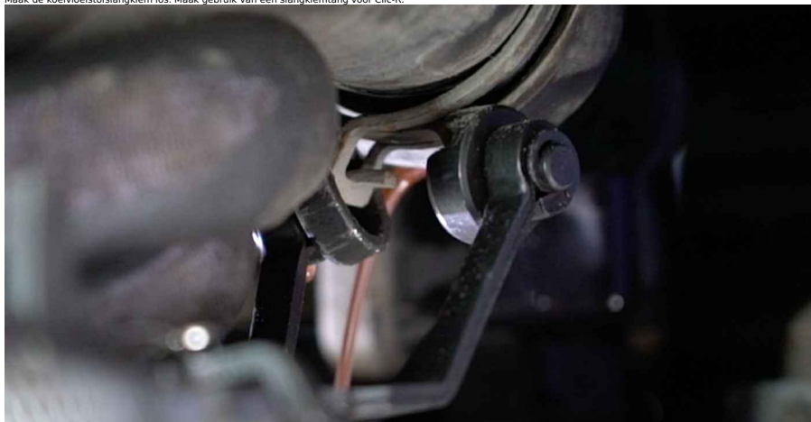
8 Koppel de koelvloeistofslang af.
