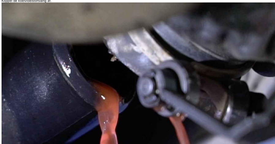
club.autodoc.nl 4-13 Vervanging: thermostaat - VAUXHALL Astra Mk1 Station Wagon. De experts van AUTODOC bevelen aan: • Opgelet! Er kan koelvloeistof uit de koelvloeistofleidingen en het thermostaathuis lekken.
