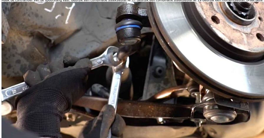
20 Installeer de splitpen die de bevestiging van het spoorstangeinde vastmaakt. club.autodoc.nl
