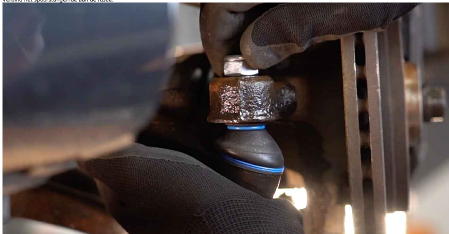
18 Draai de bevestigingsmoer die het spoorstangeind met de fusee verbindt aan. Gebruik een dop sleutel Nr.17. Gebruik een momentsleutel. Draai deze vast tot een koppel van 33 Nm.
