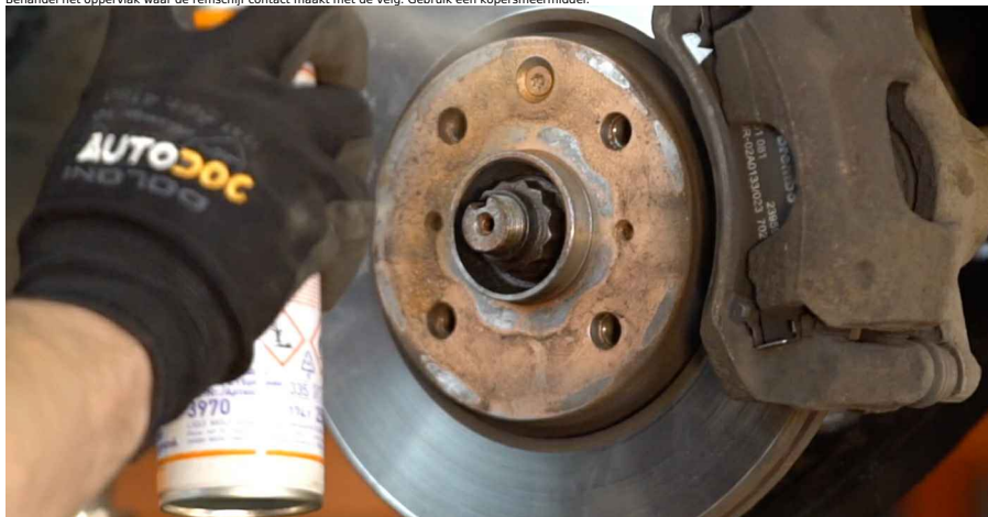
23 Reinig het oppervlak waarop de velg moet worden gemonteerd. Gebruik een remmenreiniger.
