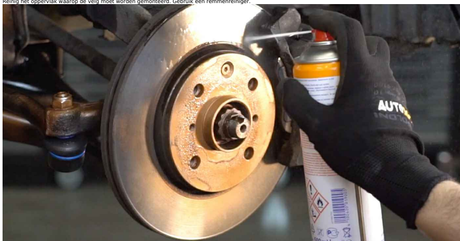
23 Reinig het oppervlak waarop de velg moet worden gemonteerd. Gebruik een remmenreiniger.
