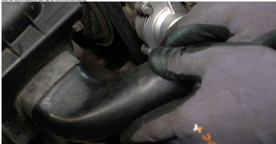
32 Maak de klem op de inlaatpijp van de luchtfilter vast.
