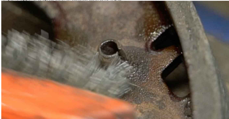
30 Verwijder de lagerbus. Gebruik een waterpomptang.
