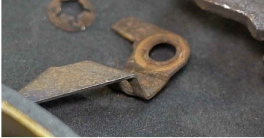
29 Reinig de montageplek van de lagerbus. Gebruik een staalborstel. Gebruik de WD-40 spray.
