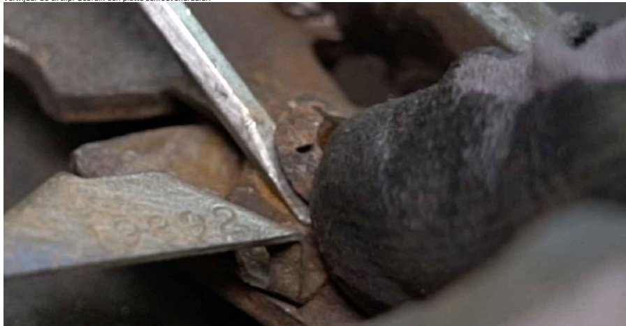
28 Verwijder het stelmechanisme voor de remschoen.
