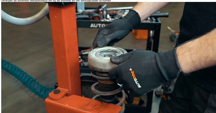
Let op! • Het aanslagrubber kan op de zuigerstang zijn gemonteerd of aan de steun zijn bevestigd • De stofhoes kan op het aanslagrubber zijn gemonteerd, tussen de veer en de steun zitten of aan de steun zijn vastgemaakt.
