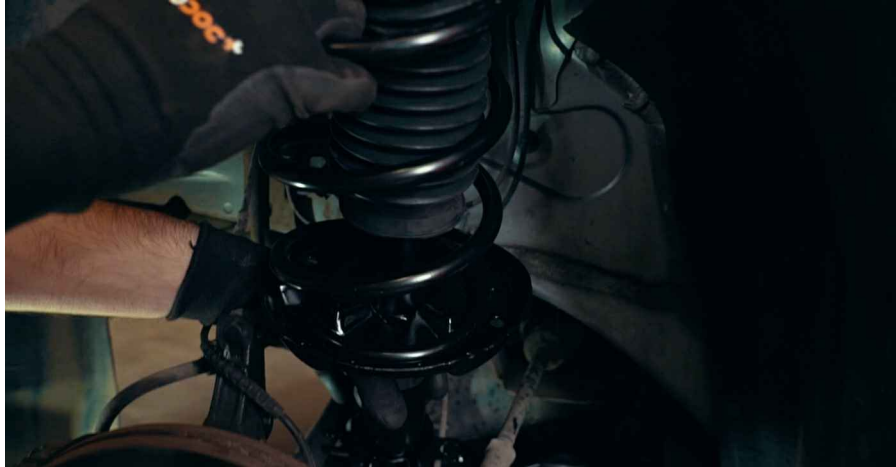
16 Haal de bevestigingen aan met het door de autofabrikant aanbevolen koppel
