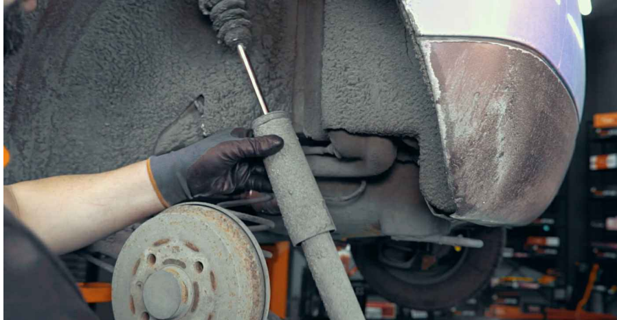
4 Mogelijkkerwijs moet de schokdemper worden gedemonteerd om bij de stofhoes en het aanslagrubber te komen
