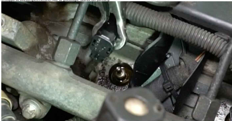
11 Reinig vuil, stof en afzetting uit de binnenzijde van de montageplaats van de bougies.
