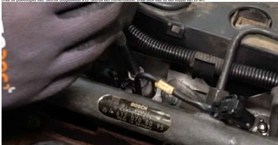
16 Draai de gloeibougies vast. Gebruik bougiesleutel #10. Gebruik een momentsleutel. Draai deze vast tot een koppel van 20 Nm.
