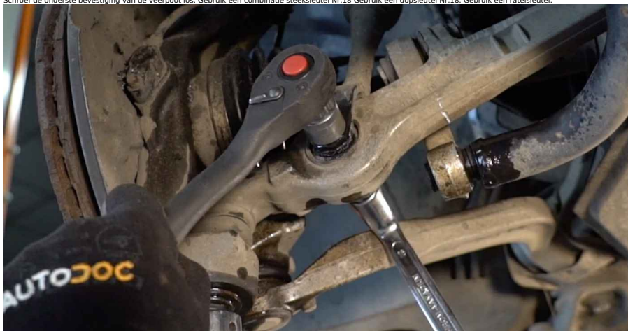
21 Verwijder de bevestigingsbout.
