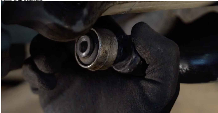
67 Span de bevestiging van de koppelstang aan.
