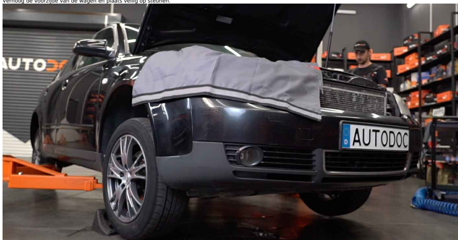
10 Draai de wielbouten los.
