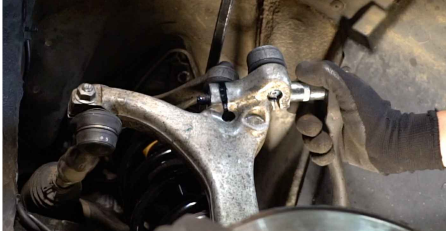
66 Installeer de dwarse koppelstang.
