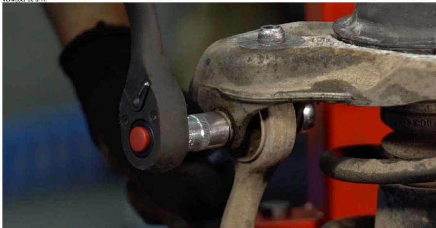
34 Schroef de bevestigingsmiddelen die de draagarmen met de veerpootlager verbinden los. Gebruik een combinatie steeksleutel Nr.16 Gebruik een dopsleutel Nr.16. Gebruik een ratelsleutel.
