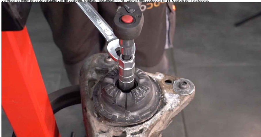
38 Verwijder de bovenste veerpootbevestiging.
