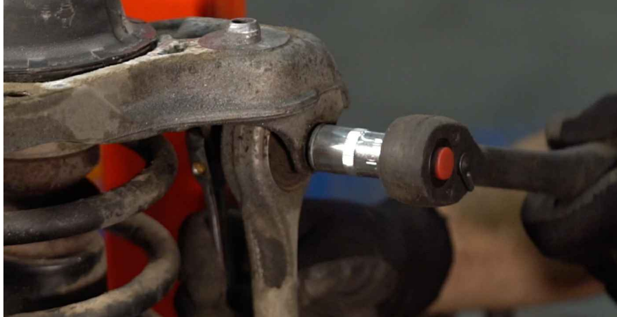
32 Verwijder de bevestigingsbout.
