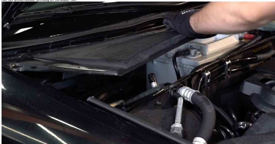
3 Hef het afvoerrooster omhoog en verwijder het.
