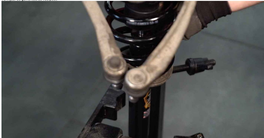
55 Installeer de veerpoot in de wielkast.
