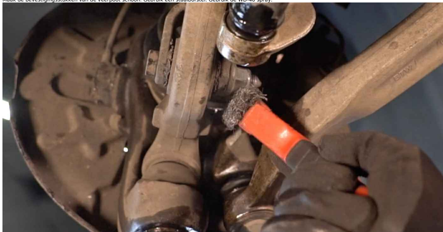
19 Maak de bevestigingsstukken van de veerpoot schoon. Gebruik een staalborstel. Gebruik de WD-40 spray.
